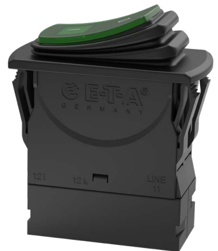
Thermischer Schutzschalter Typ 3120-N mit innovativer Faltenbalgabdichtung (IP65) und Push-in Anschlussstechnik
